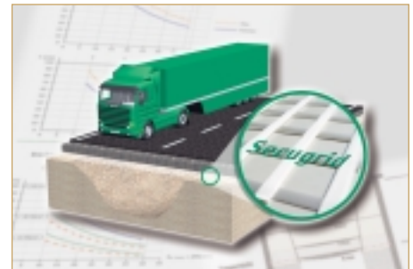
Secugrid® Geogitter zur Sicherung von Verkehrswegen über Erdfallgebieten.
